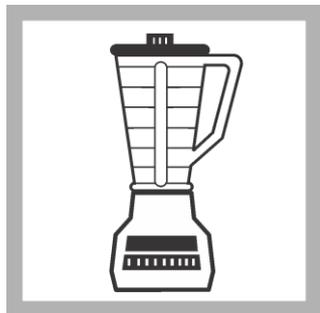
1. Coloque 100 mL da amostra no liquidificador. Bata por 30 segundos ou até homogeneizar. Para amostras com grandes quantidades de sólidos, aumente o tempo de homogeneização. Se a amostra não contém sólidos suspensos, vá para o passo 3.
