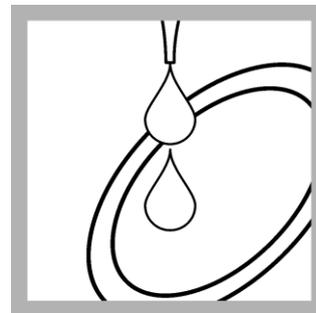
4. **Prepare a amostra:** Remova a tampa do frasco da faixa selecionada. Mantenha o frasco em um ângulo de 45°. Use uma pipeta limpa para adicionar 2.00 mL de amostra ao frasco. Para frascos de 250-15000 mg/L: use pipeta TenSette para adicionar 0,20 mL de amostra.
