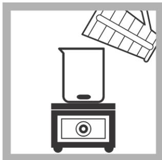
2. Para faixa 200–15,000 mg/L ou para melhorar a precisão e reprodutibilidade de outras faixas, coloque a amostra homogeneizada em um béquer de 250 mL e gentilmente agite com um agitador magnético.
