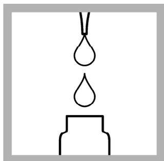
1. Use uma pipeta para adicionar 2 ml da solução A no tubo de reagente.
