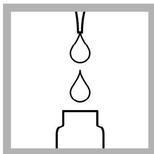
2. Use uma pipeta para adicionar 3ml de amostra no tubo de reagente.
